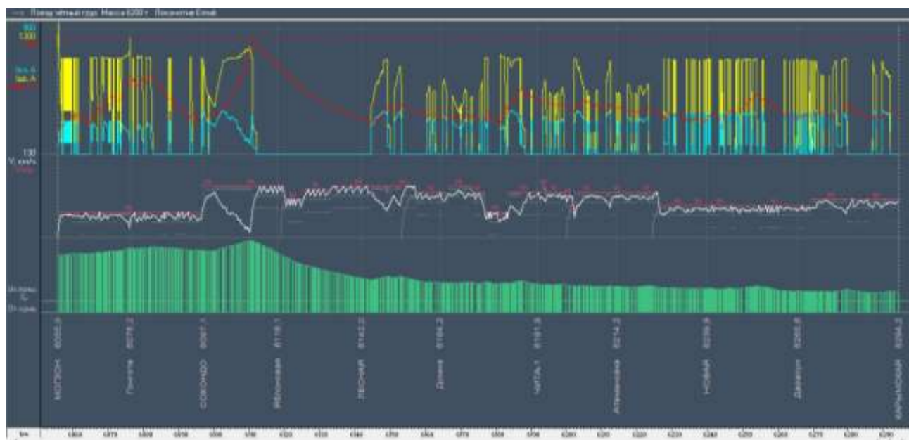
Рис. 2. Тяговые расчеты локомотива Ермак массой 6200 т. выполнены с учетом четного направления без рекуперативного торможения
