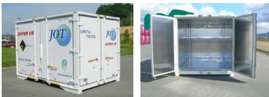
Рис. 4. Усиленный 12-футовый рефрижераторный контейнер
