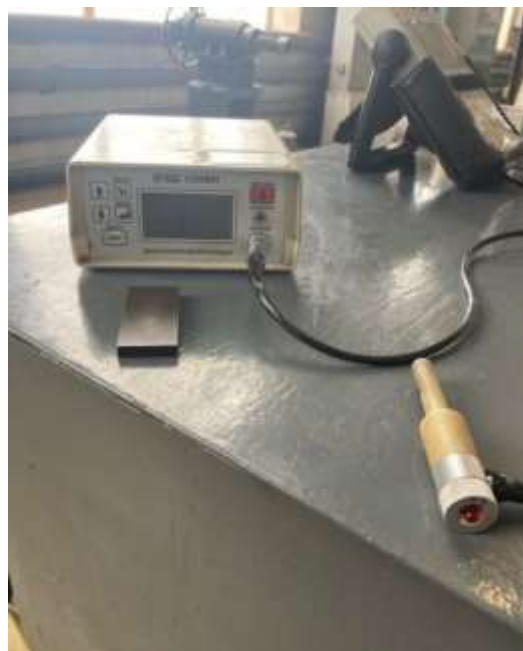
Рис. 4. Прибор ВД-12НФП для проведения электромагнитного неразрушающего контроля
