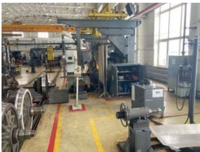
Рис. 1. Участок по проведению неразрушающего контроля литых деталей
