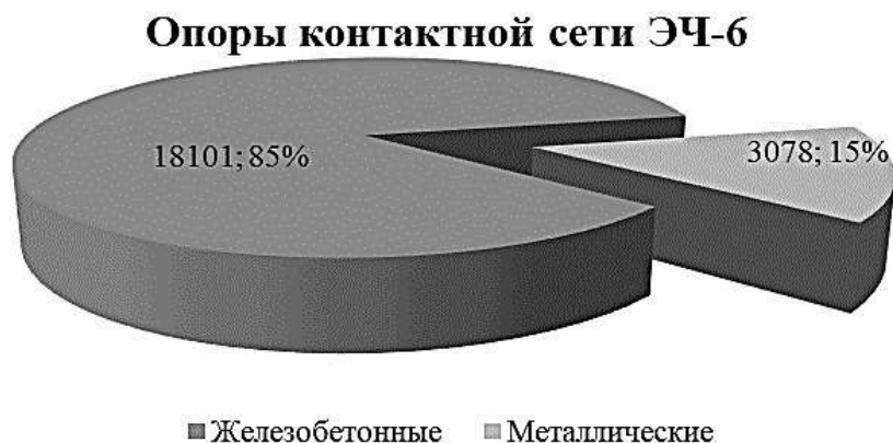
Рис. 1. Опорное хозяйство Абаканской дистанции электроснабжения
