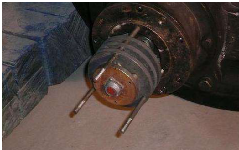
Рис. 3. Размещение токосъемного устройства на буксе колесной пары
