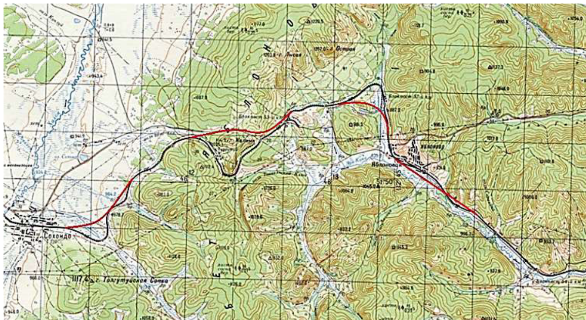
Рис. 3. Вариант укрупненной реконструкции участка
