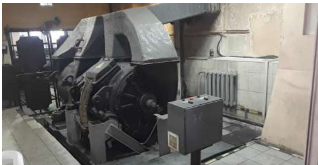
Рис. 3. ТЭД, включённые методом взаимной нагрузки
