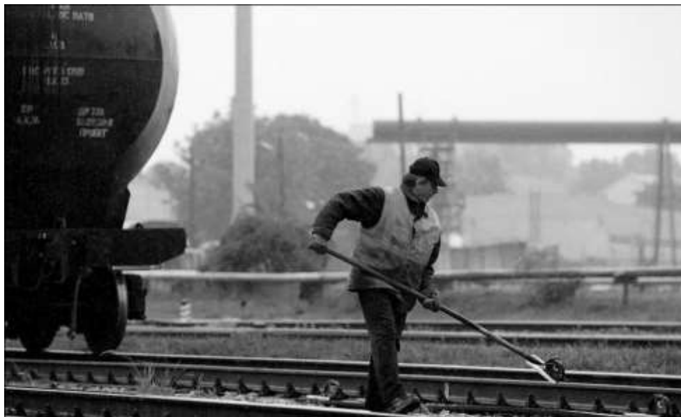
Рис. 1. Регулировщик скорости движения вагонов в опасной зоне парковой тормозной позиции
