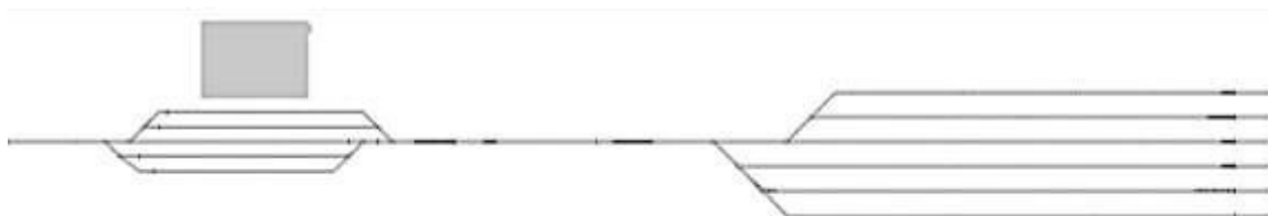
Рис. 5. Пример применения цифрового двойника на железнодорожном транспорте в программе AnyLogic – сортировка вагонов по путям в зависимости от вида подвижного состава
