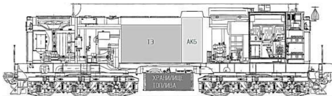
Рис. 1. Расположение оборудования на ТЭМ18ДМ с топливными элементами
