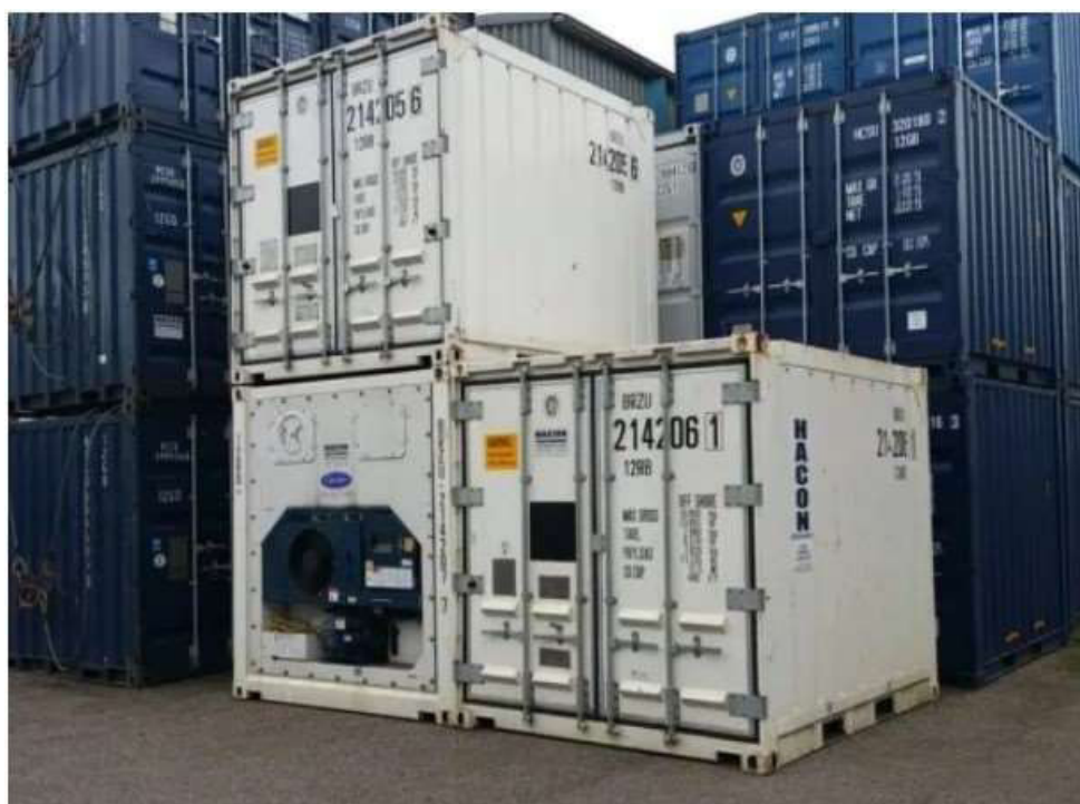
Рис. 6. Среднетоннажные контейнера с холодильным оборудованием
