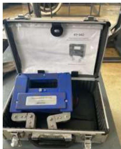
Рис. 2. Прибор КУ-140 для проведения магнитного неразрушающего контроля
