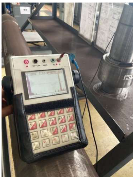
Рис. 3. Прибор УД2-102 для проведения акустического неразрушающего контроля
