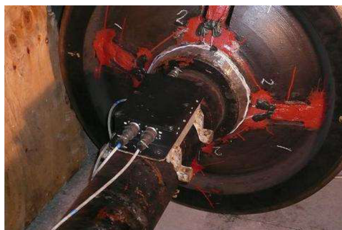
Рис. 2. Размещение тензометрического усилителя на оси колесной пары
