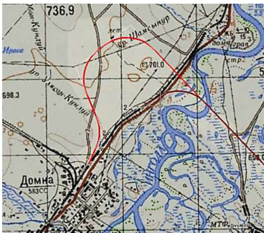
Рис. 4. Вариант 1, 2 трассы на станции Домна
