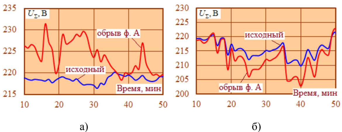
Рис. 5 (начало). Эффективное напряжение фаз А (а), В (б) и С (в) на стороне 0,4 кВ КТП ДПР
