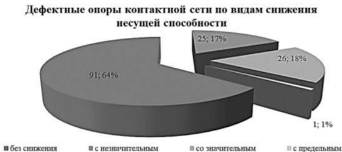
Рис. 4. Дефектные опоры контактной сети по видам снижения несущей способности
