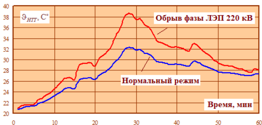
Рис. 6. Температура наиболее нагретой точки трансформатора ТП 1
