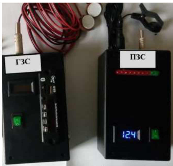
Рис. 2. Устройство идентификации проводов и жил кабелей с использованием акустического сигнала
