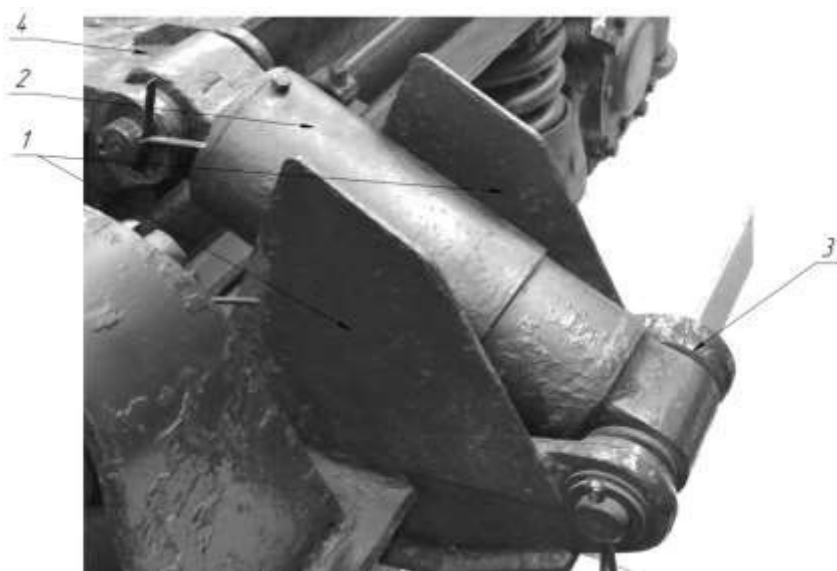
Рис. 3. Снегоотражающие щитки для гидрогасителей тележек пассажирских вагонов ТВЗ-ЦНИИ: 1 – снегоотражающие щитки, 2 – гидрогаситель, 3, 4 – места крепления гидрогасителя к раме тележки
