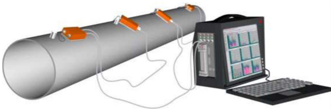
Рис. 1. Акустический метод идентификации жил нагруженного кабеля
