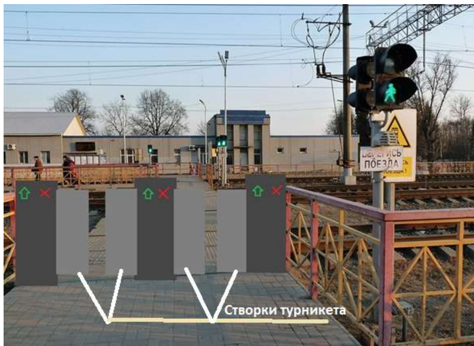
Рис. 6. Иллюстрация установленного двухстворчатого турникета в зоне накопления пешеходов на границе выхода к железнодорожным путям
