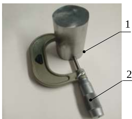
Рис. 5. Схема измерений среднего диаметра РК-5 профильного вала: 1 – РК-5 профильный вал; 2 – микрометр МК
