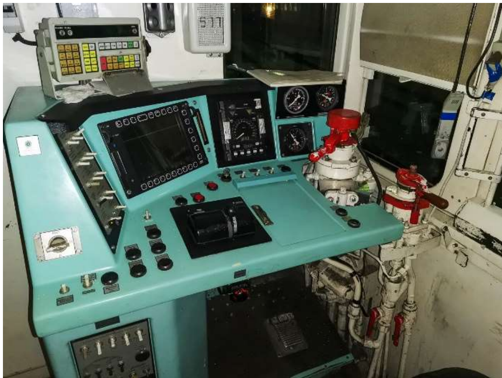
Рис. 2. Пульт управления машиниста для тепловоза ТЭМ18ДМ
