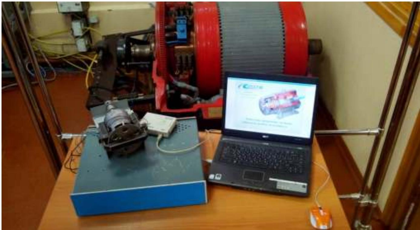
Назначение: оценка качества установки щеток тягового электродвигателя локомотива. Обеспечивает установку щеток тягового электродвигателя на геометрическую нейтраль в автоматическом режиме. Автоматизированная система включает в себя:
