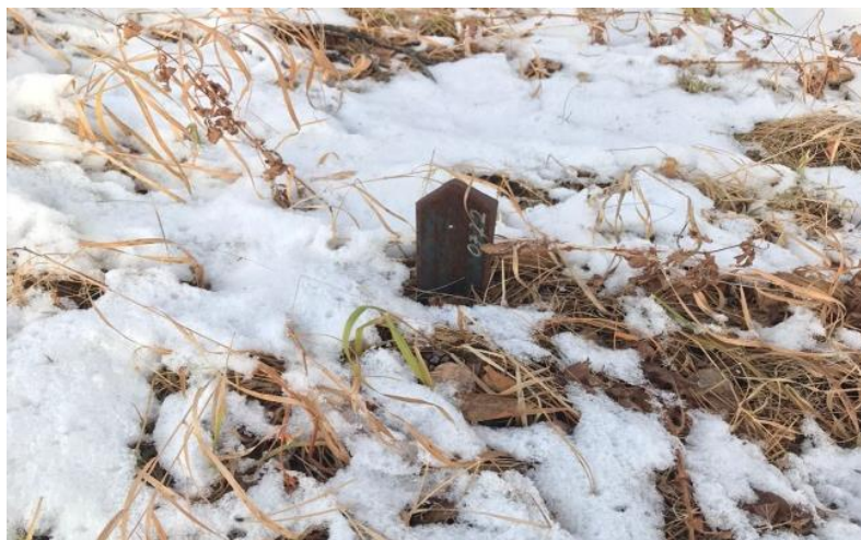
Рис. 2. Пример временного закрепления (металлический уголок)
