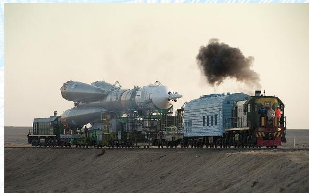
с платформой-установщиком различными трубопроводами. Скорость движения состава строго ограничена 5 км в час. При транспортировке ракеты потяжелее, нежели «Союз», используются два тепловоза — спереди и сзади, так как путь имеет хотя и небольшие, но затяжные уклоны. Машинист не может контролировать такую скорость по
